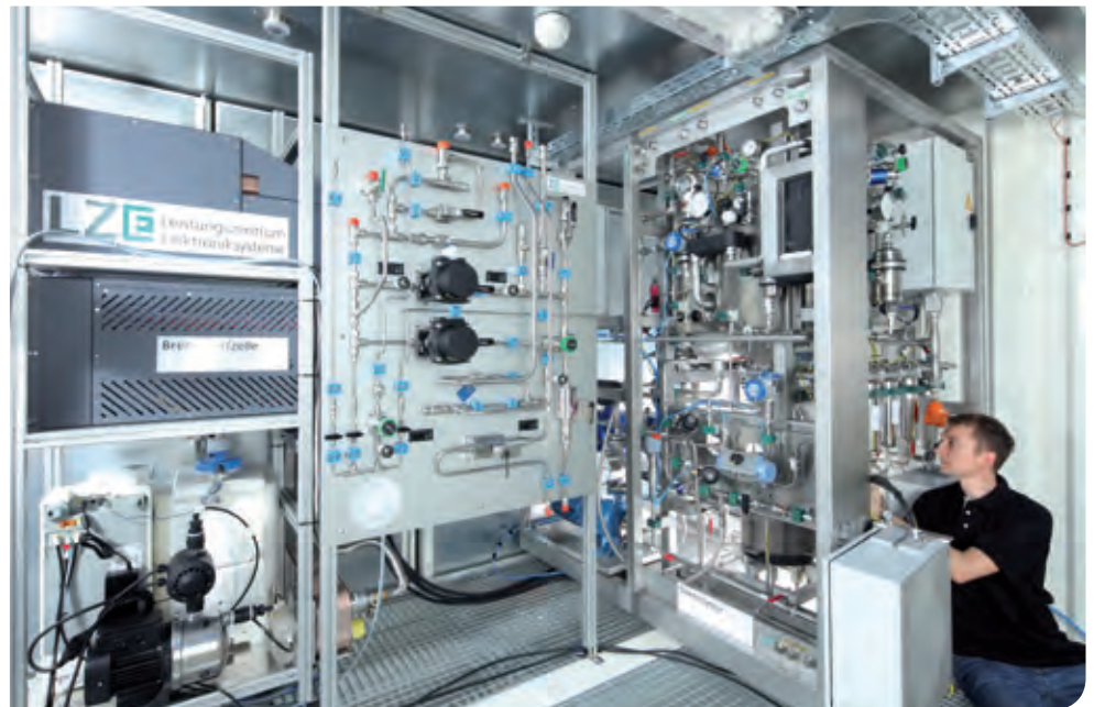
Im Inneren des neuartigen LOHC-Containers ermöglichen ein Elektrolyseur (rechts) und eine Brennstoffzelle (links) die effiziente Produktion und Verstromung von Wasserstoff. © Fraunhofer IISB/ Kurt Fuchs
