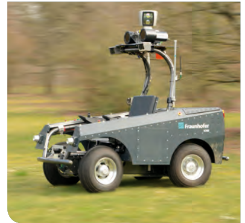
Das vollständig autonome Fahrzeug »IOSB.amp Q1« kann auch unwegsames Gelände selbstständig erkunden. © Fraunhofer IOSB
