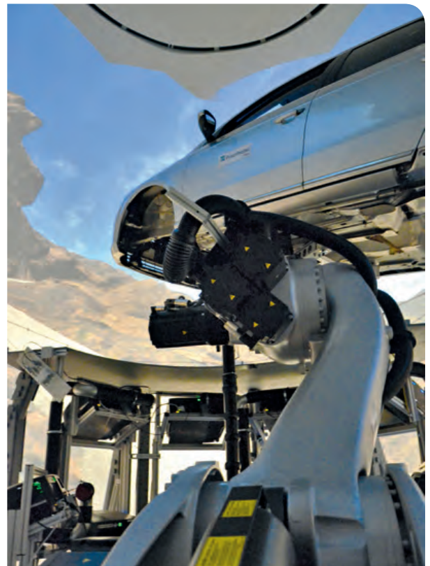
Das RODOS®-System erspart Fahrzeugentwicklern Prototypen-Tests unter realen Bedingungen. Hier zu sehen: interaktive Fahrsimulation mit Pkw-Chassis. © Fraunhofer ITWM
