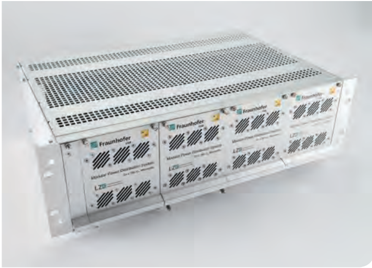
Für die Einspeisung von Sonnenstrom wird das modular aufgebaute Leistungsverteilsystem für Gleichstromnetze genutzt. Integriert ist ein innovativer Energieflusskontrollier zur Stabilisierung und Spannungsregelung. © Fraunhofer IISB/Kurt Fuchs
