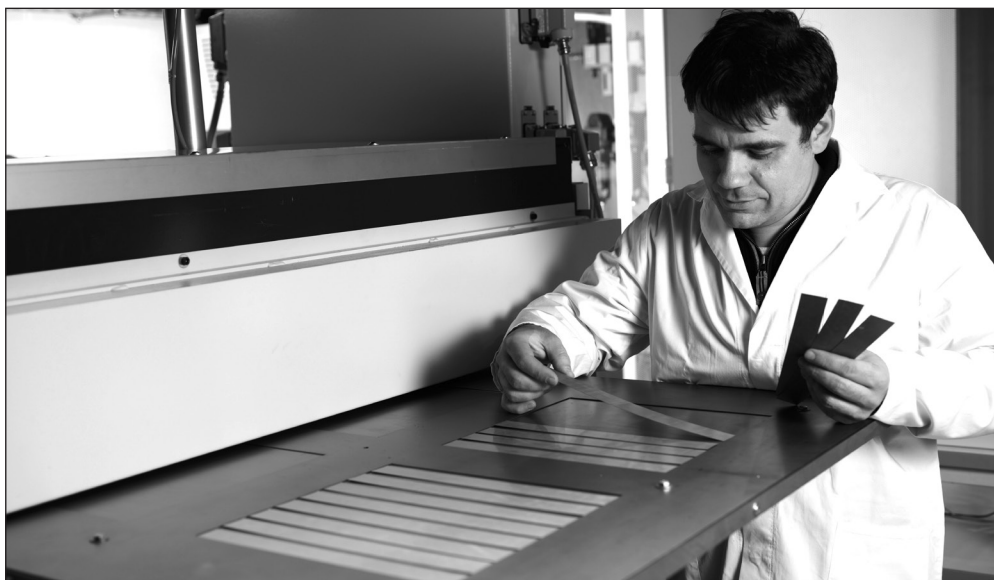
Ein Wissenschaftler entnimmt Elektroblechproben aus der Versuchsanlage am Fraunhofer IWS. Die Bleche sind wichtiger Baustein von Transformatoren. (© Fraunhofer IWS) | Bild in Farbe und Druckqualität: www.fraunhofer.de/presse
