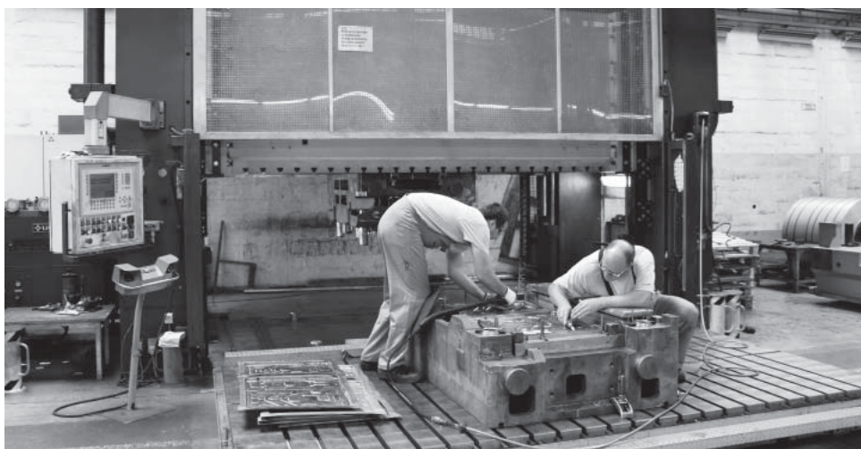
Facharbeiter installieren bei Gorenje Sensoren in das Werkzeug einer Umformmaschine, die Bauteile für Haushaltsgeräte presst. (© Gorenje Group) | Bild in Farbe und Druckqualität: www.fraunhofer.de/presse
